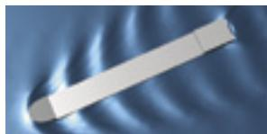
Рис. 5. Система волн около тихоходного грузового судна
