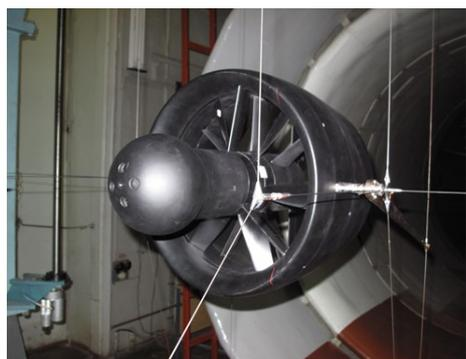
Спроектированный монокоптер был исследован в АДТ. Было выполнено экспериментальное определение сил и моментов, действующих на модель БПЛА в зависимости от угла атаки, положения органов управления и величины относительной скорости вращения ротора. На рисунке 3 показаны полученные результаты для относительной скорости равной 0,175 (число оборотов в минут 2500, набегающий поток 8 м/с).
