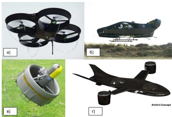
Существенной особенностью аэродинамики таких БПЛА является то, что значительная часть аэродинамической силы образуется на корпусе. Это требует детального изучения особенностей взаимодействия ротор кольцевых двигателей друг с другом в случае применения нескольких близкорасположенных двигательных модулей.
