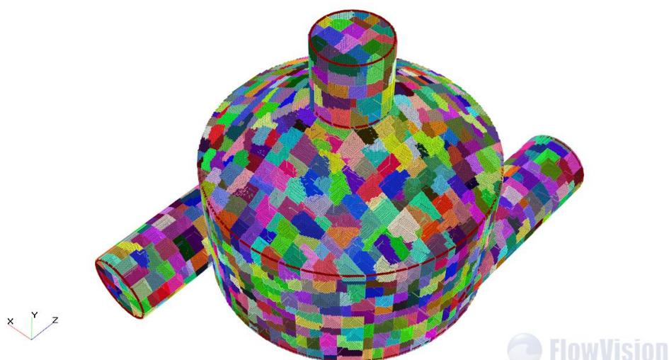
**Рис. 3.** Структурирование расчетной сетки по гиперячейкам
