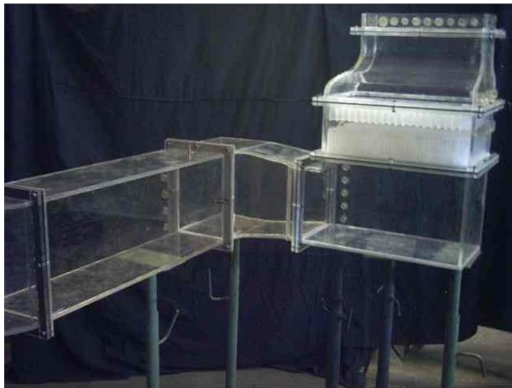
Рис.3. Аэродинамическая модель воздуховода ГТЭ-110 Ивановской ГРЭС
