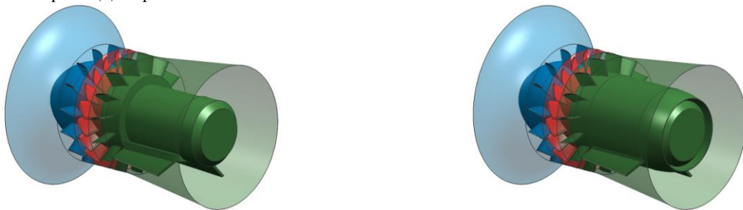
Рис. 4 – Вентилятор с открытым и закрытым электродвигателем.
