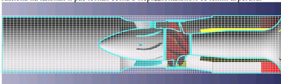
Рис. 8 – Начальная сетка в меридиональном сечении агрегата
