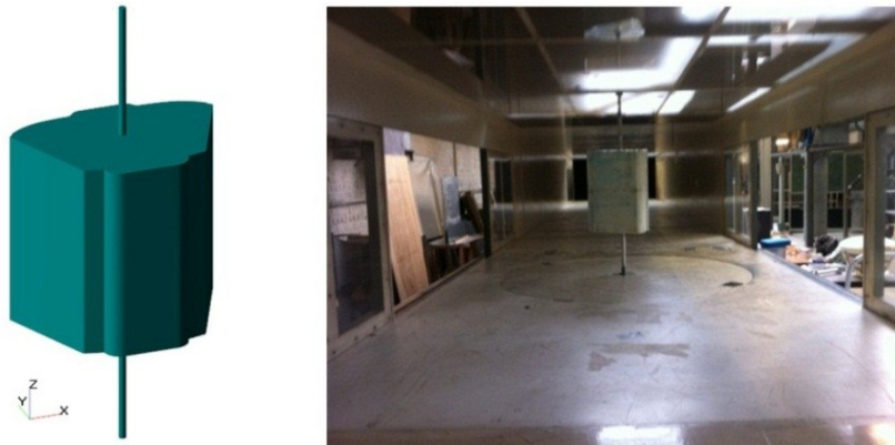
Рис. 3 – Масштабная модель длиной 460 мм (слева). Расположение масштабной модели в аэродинамической трубе (справа)
