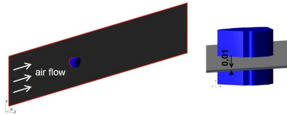
Рис. 4 – Геометрия расчетной области во FlowVision.
