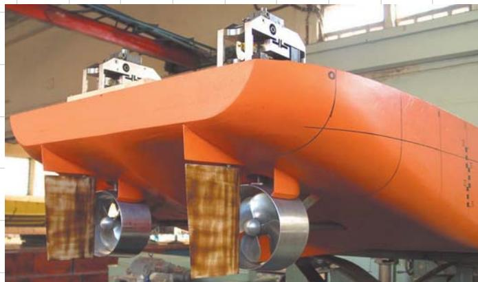
Рис. 5. Трехмерная модель компоновки движительно-рулевого комплекса (T-FLEX CAD) и самоходная модель судна ограниченного плавания, выполненная ЦНИИ им. акад. А.Н.Крылова
