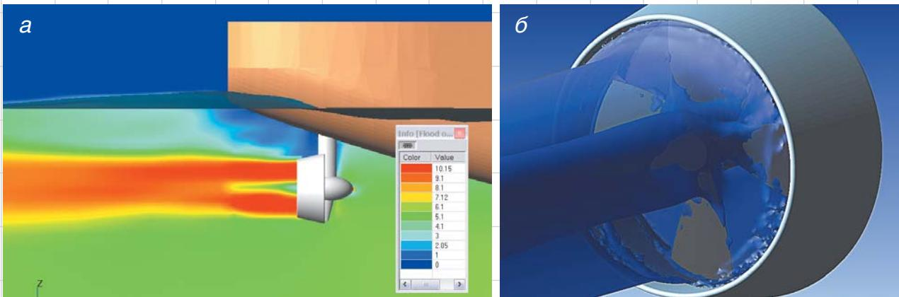
Рис. 6. Моделирование взаимодействия судовых движителей с корпусом судна численными методами:
