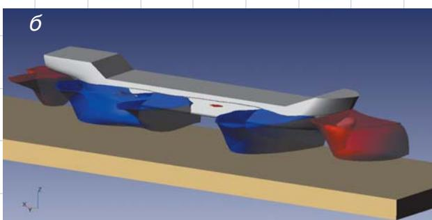
Рис. 9. Изоповерхность динамического давления 2500 Па (синим цветом показано отрицательное давление, красным — положительное):
