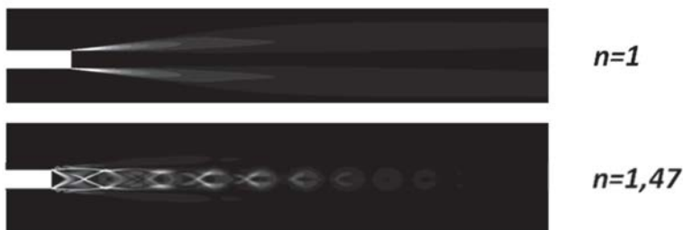
Рисунок 55 – Сравнение теневой картины в плоскости симметрии сопла для двух расчетных случаев тестов Сейнера
