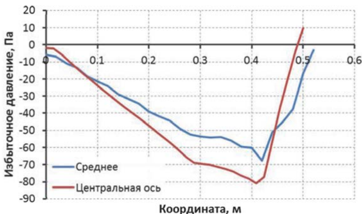
Рисунок 35 - Распределение среднего давления по длине и давления вдоль центральной оси воздухоохладителя
