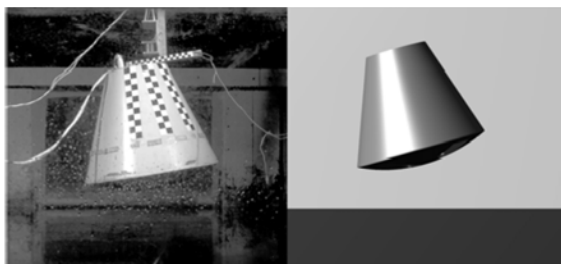
Рисунок 66 – Модель ВА ПТК в расчёте и эксперименте
