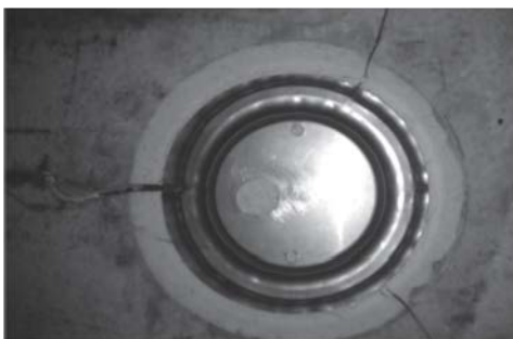
Рисунок 144 – Разрушение матрицы при проведении эксперимента штамповки эластичной средой
