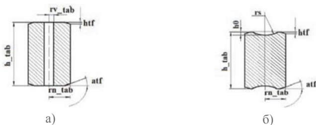
Рисунок 122 – Эскизы таблеток с наборами геометрических параметров а – таблетка с центральным отверстием; б – таблетка со сферической канавкой
