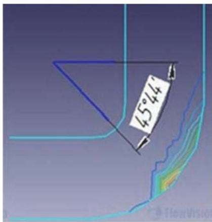
Рисунок 102 – Распределение концентрации абразива массой 0,25 кг при диаметре частиц 1,0 мм
