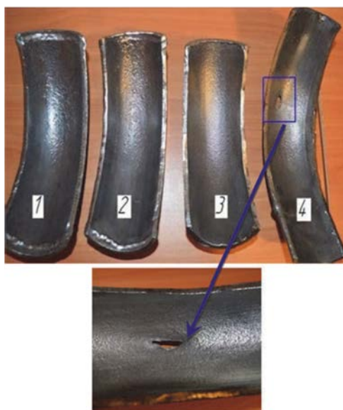
Рисунок 93 – Внутренняя поверхность фрагментов отводов с газоабразивным износом
