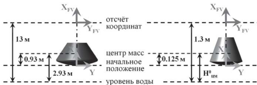
Рисунок 63 – Системы координат для модели Apollo и модели ВА ПТК
