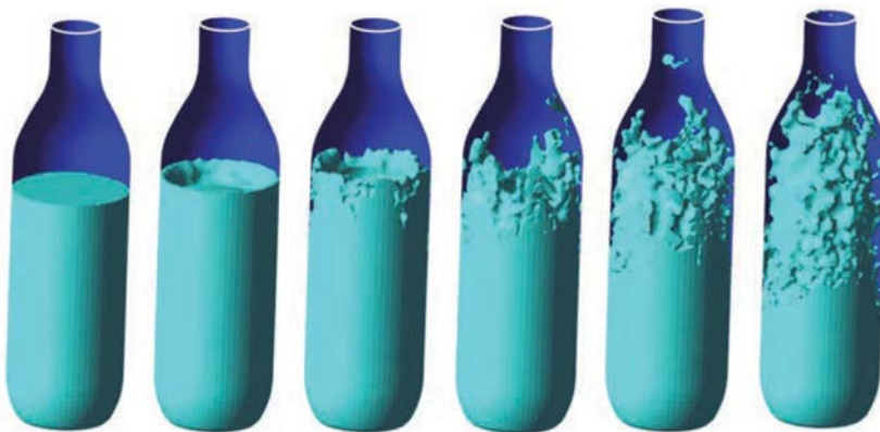
Рисунок 80 – Свободная поверхность воды в моменты времени от начала расчета до 0.03 сек. с шагом 0.005 сек.
