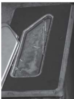
Рисунок 144 – Разрушение матрицы при проведении эксперимента штамповки эластичной средой
