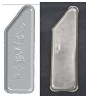
Рисунок 141 – Сравнение результатов моделирования с экспериментом Расхождение по геометрии фланца. Возникновение эффекта не плоскостность
