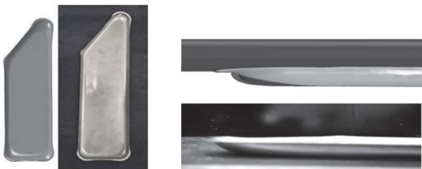
Рисунок 143 – Сравнение результатов моделирования, где тип имитации эластичной среды деформируемое тело (модель полиуретана) с реальным экспериментом
