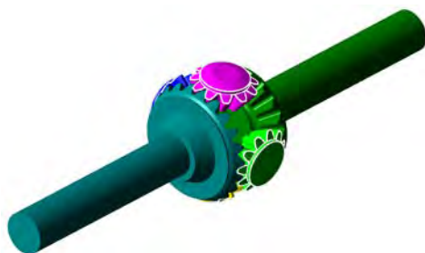
Рисунок 2 – Твердотельная модель фрагмента картера моста в сборе
