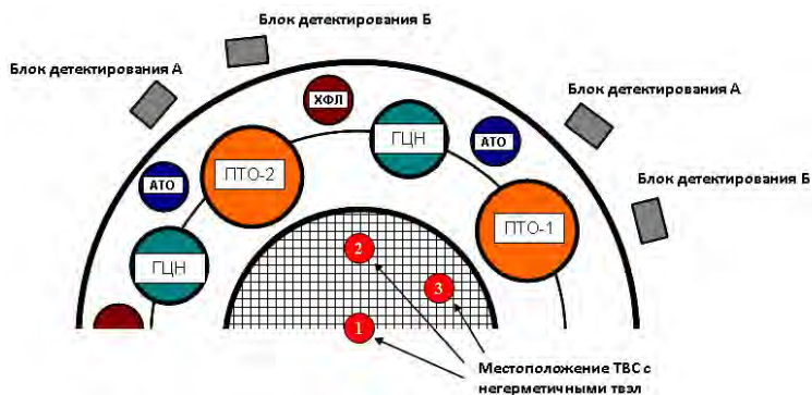
Рисунок 3 – Местоположение ТВС с негерметичными твэл и расположение блоков ССКГО
