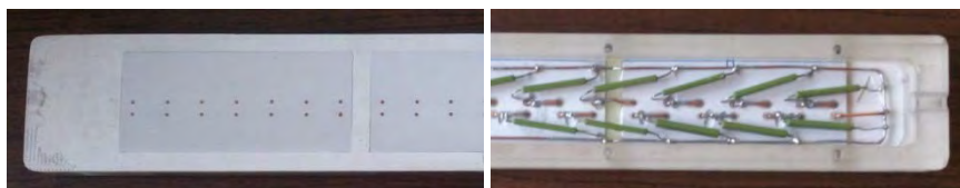
Рисунок 2 - Актуатор с тремя пластинами 44х100, укомплектованный 21 парой электродов, вариант с продольным разрядом. Вид на актуатор сверху (слева) и снизу (справа)
