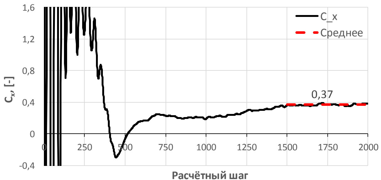
Рис. 5. Сходимость коэффициента C_x в процессе расчёта
