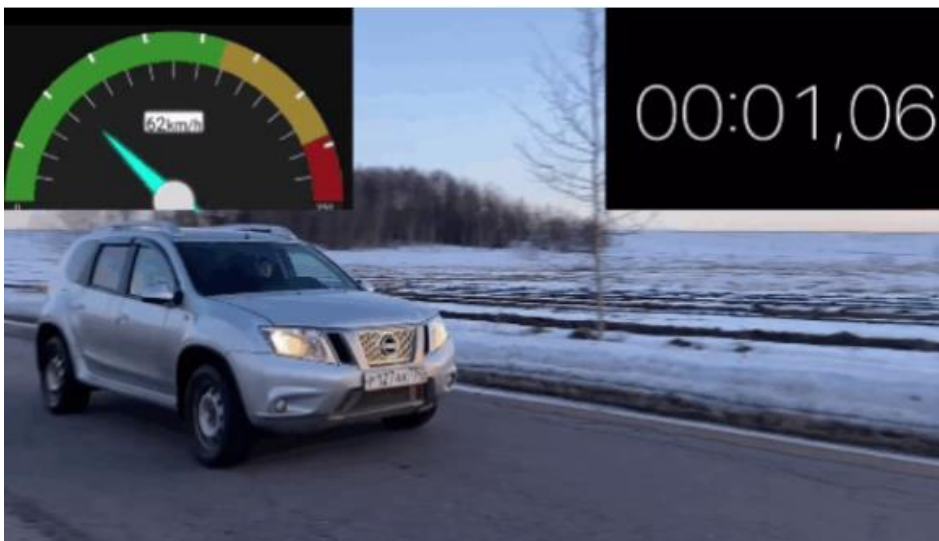
Рис. 6. Замер времени замедления при экспериментальном определении коэффициента аэродинамического сопротивления
