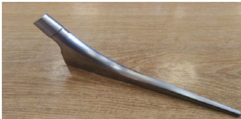
Проектирование управляющей программы обработки импланта и готовый имплант
