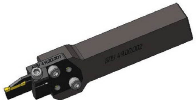
Модель сборки резца в КОМПАС-3D
