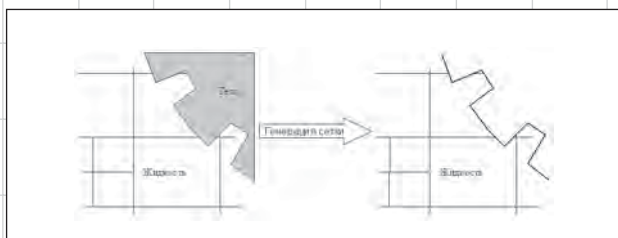
Рис. 3. Генерация расчетной сетки
