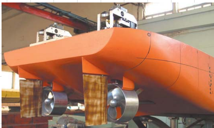
Рис. 5. Трехмерная модель компоновки движительно-рулевого комплекса (T-FLEX CAD) и самоходная модель судна ограниченного плавания, выполненная ЦНИИ им. акад. А.Н.Крылова
