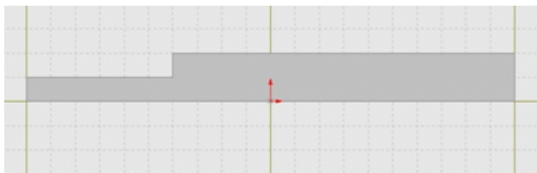
Рис. 2.9. Геометрия резко расширяющегося канала
