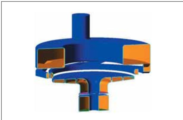
Рис. 1. Расчетная геометрия насоса
